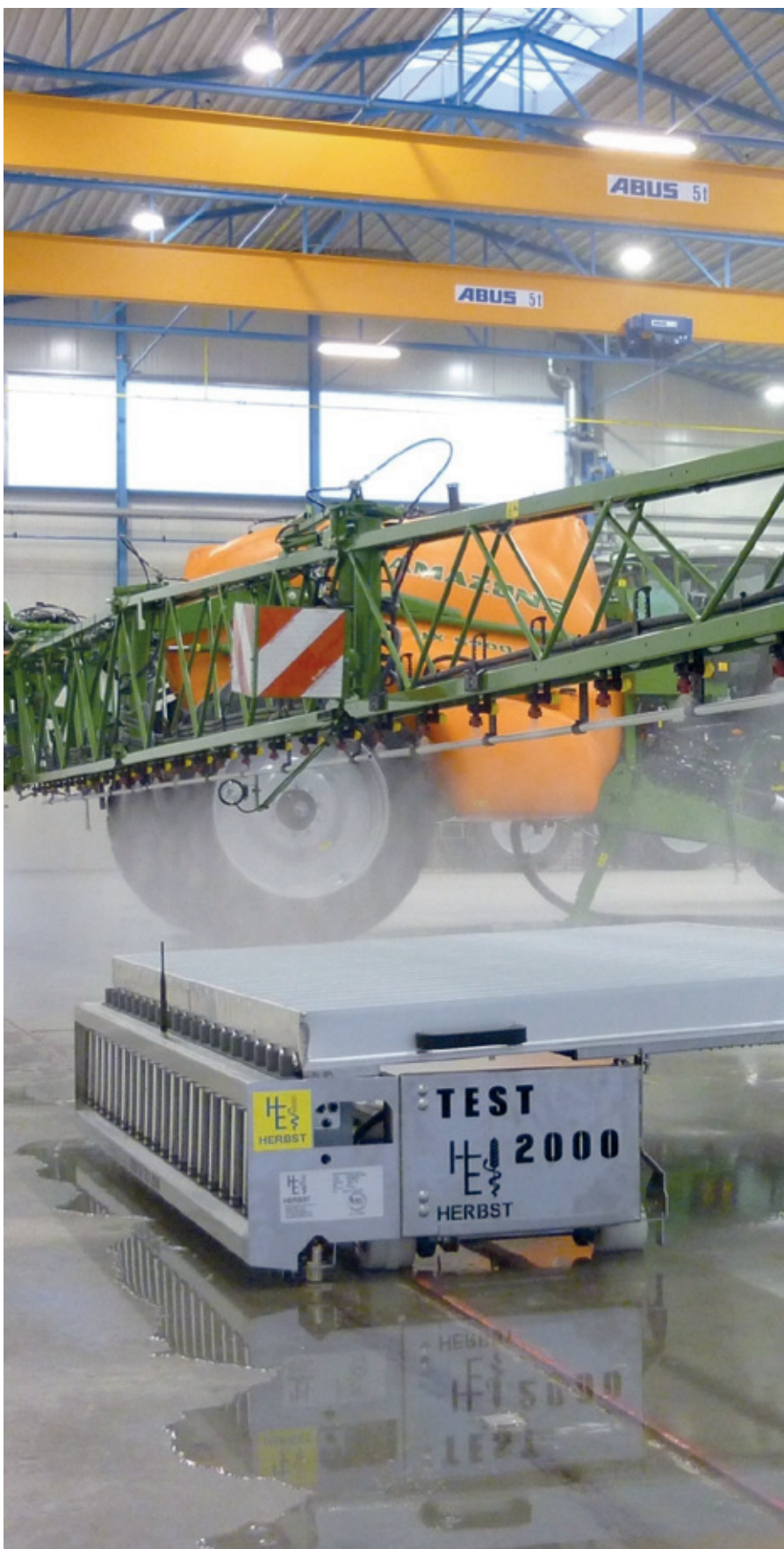
Рис. 1. Мобильный измерительный стенд для тестирования оборудования опрыскивателя Sprayer Test 2000 компании Ernst Herbst Prüftechnik e.K.
